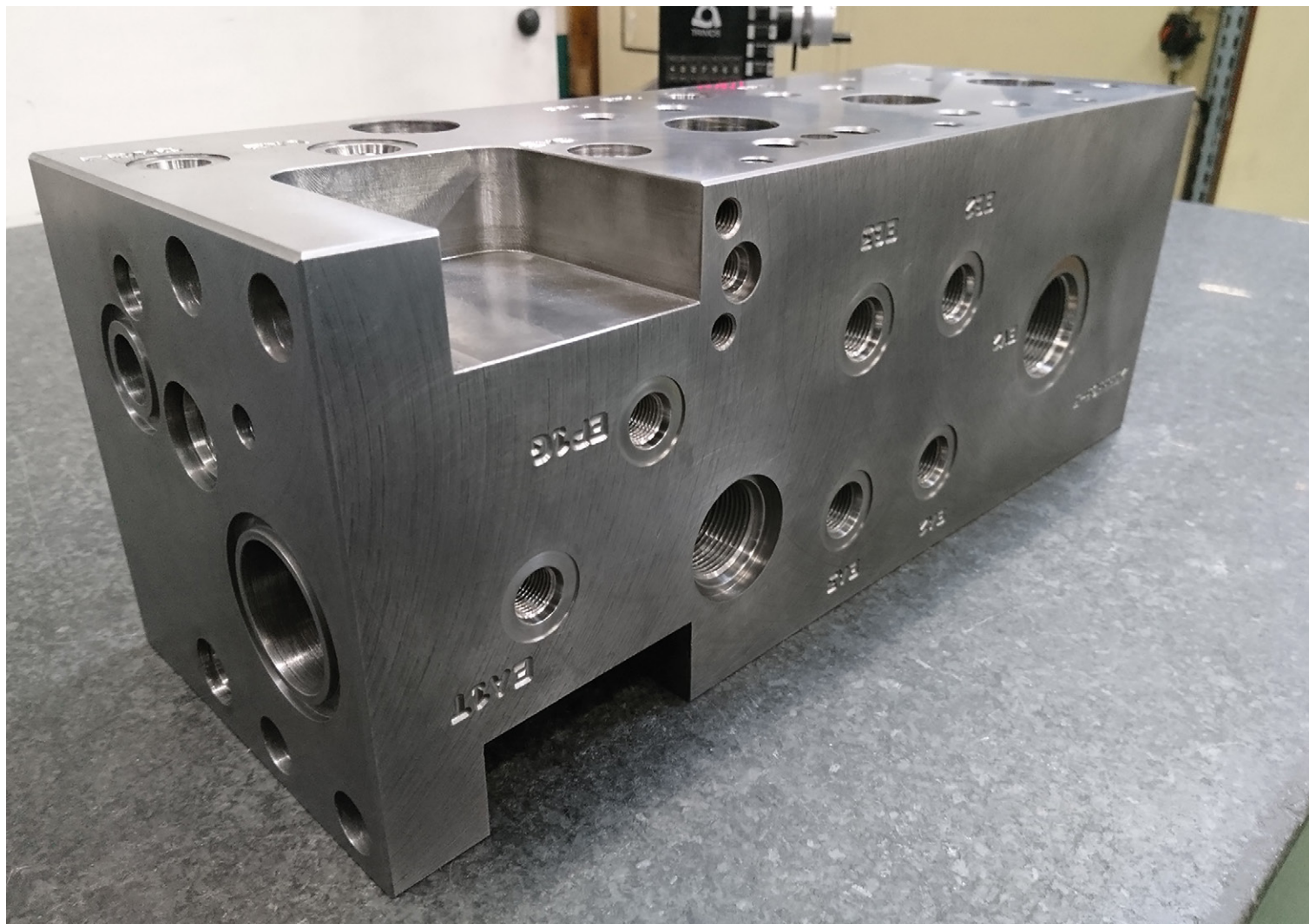
La question de la compacité du bloc foré se pose avec acuité, remarque Mecabor. Le bloc doit s'intégrer dans un espace contraint.
