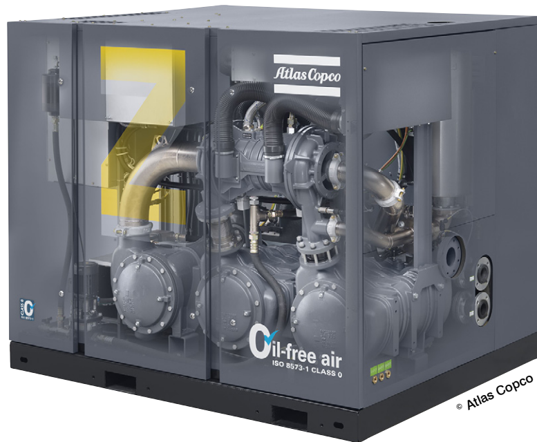
L'air produit dans les trois étages de compression du ZH350+ est certifié à 100% sans huile selon la norme ISO 8573-1 Class 0 (2010), ce qui signifie qu'il n'y a aucun risque de contamination ou de produits endommagés.
