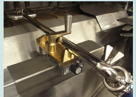
Une table linéaire à vis au jeu réglable assure le réglage de la position du tube d'arrivée de la pâte.
