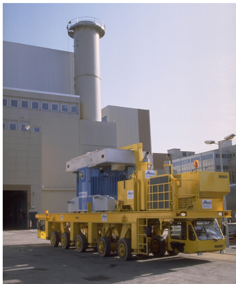
© AREVA, Jezequel Sidney Transfert des déchets vitrifiés de l'atelier T7 à celui de désentreposage de NPH. AREVA, établissement de La Hague. France.
