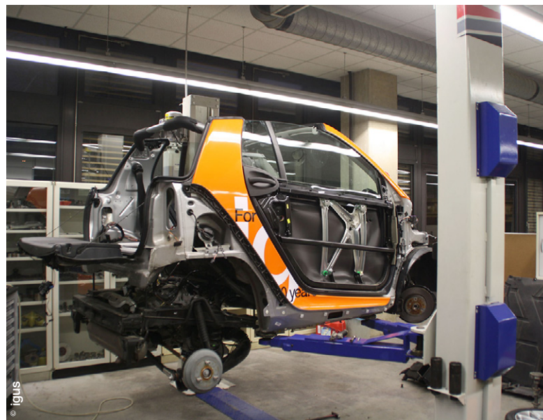
Le "désossage" complet du véhicule a permis d'identifier 56 points de logements pour les paliers lisses iglidur.
