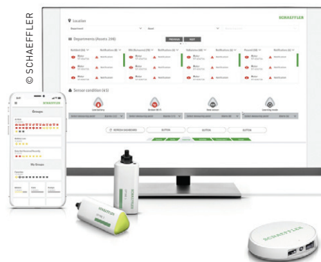
Le signal remonte vers une passerelle, et de là vers le cloud, pour être analysé, par cycle d'une seconde.
