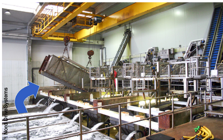
Des coquillages vivants sont acheminés sur des chaînes de convoyeurs depuis de grands conteneurs d'eau salée, qui créent une atmosphère très agressive.
