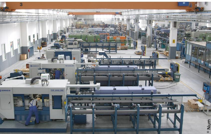
Les nouvelles machines Sinico TOP 2000ri utilisent un système de commande de mouvement 9 axes développé en collaboration avec Num. Le système Num Flexium 68 CNC se charge du contrôle global de la machine.
