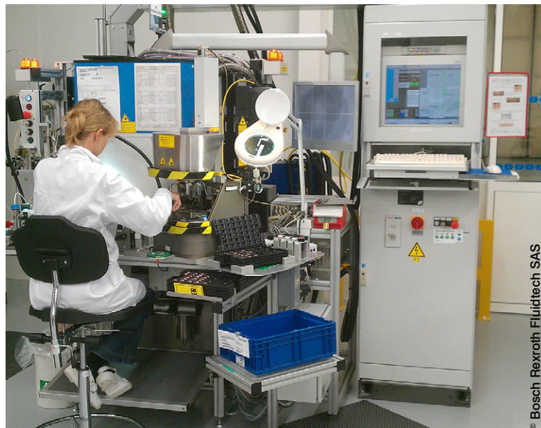
L'assemblage du PVP1 s'effectue de manière totalement automatisée au sein d'une nouvelle salle en atmosphère contrôlée et température régulée.
