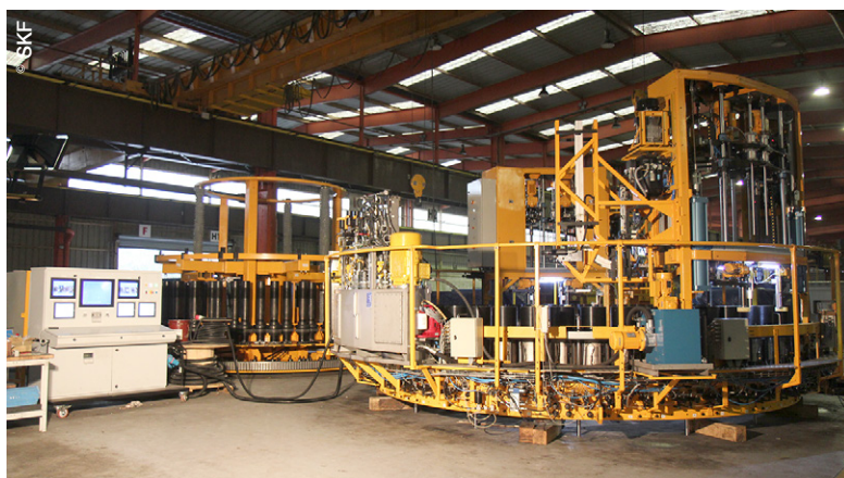
Vue du hall d'assemblage de la machine de serrage MSDG 21M (France, janvier 2013) : le pupitre de commande, le stand et la machine proprement dite.
