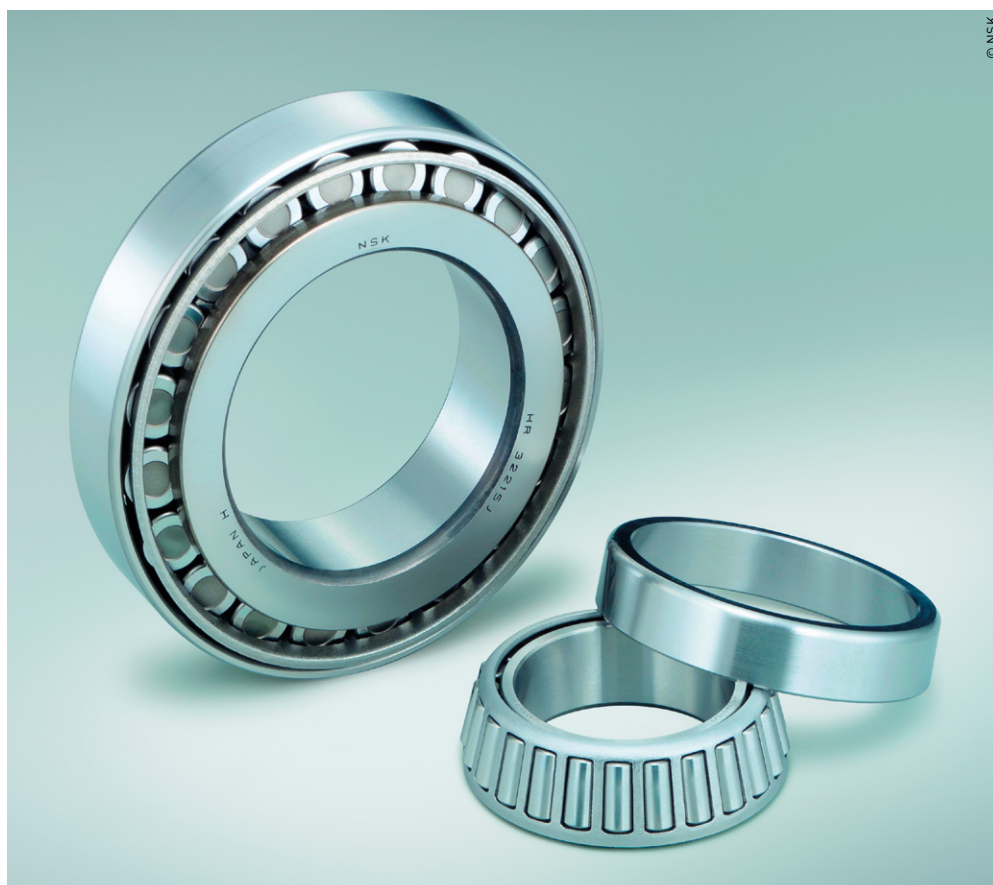
Les roulements à rouleaux coniques NSK série HR peuvent supporter des charges radiales et axiales élevées dans un seul sens.
