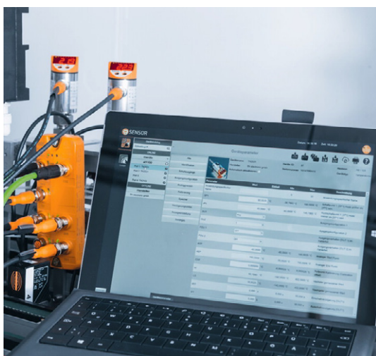
Le LR Device est un logiciel qui permet le paramétrage facile, rapide et fiable de tous les capteurs, actionneurs et maîtres IO-Link.
