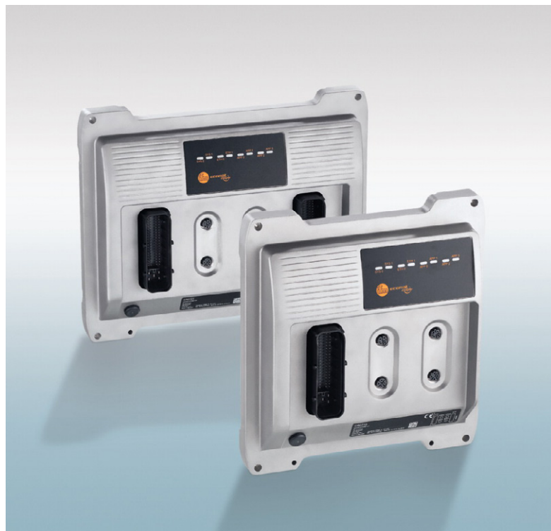
La troisième génération d'EcomatController d'ifm electronic intègre un contrôleur standard et de sécurité dans un seul appareil.
