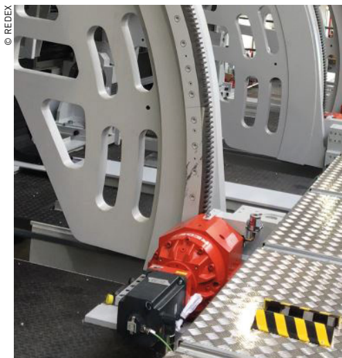
Les centres d'usinage Ecospeed F de Starrag ont été utilisés pour la production de nervures d'ailes et autres éléments structurels d'avions. Quatre couronnes d'orientation font tourner de 90° la pièce de 10 mètres de long avec le composant à usiner.
