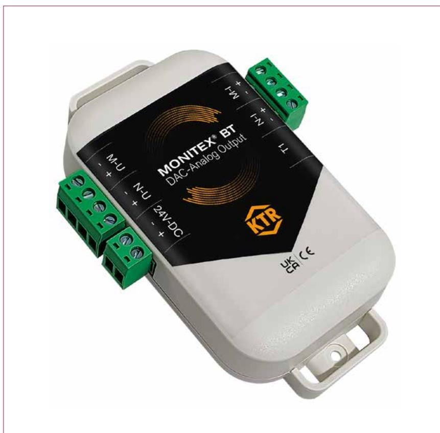
Le convertisseur numérique-analogique (DAC) se connecte automatiquement au moyeu d'accouplement et fournit les données de couple et de vitesse sous forme de tension et de courant analogiques. En plus de l'application gratuite et du logiciel Windows, les signaux peuvent désormais être directement reliés à des commandes ou à des acquisitions de données de mesure existantes.
