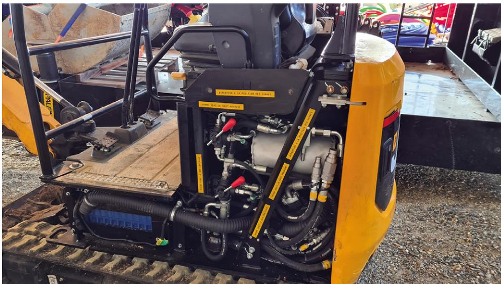
RPS a participé à la préparation de l'alimentation d'une mini-pelle JCB par un moteur électrique.
