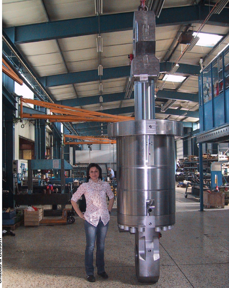
Vérin de tensionneur pour pose de pipe.
