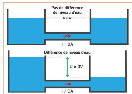
de pression entre l'entrée et la sortie du tuyau. Plus la différence de pression est élevée, plus l'eau peut circuler facilement. Dans l'exemple ci-dessus, pour que l'eau s'écoule du récipient gauche vers celui de
