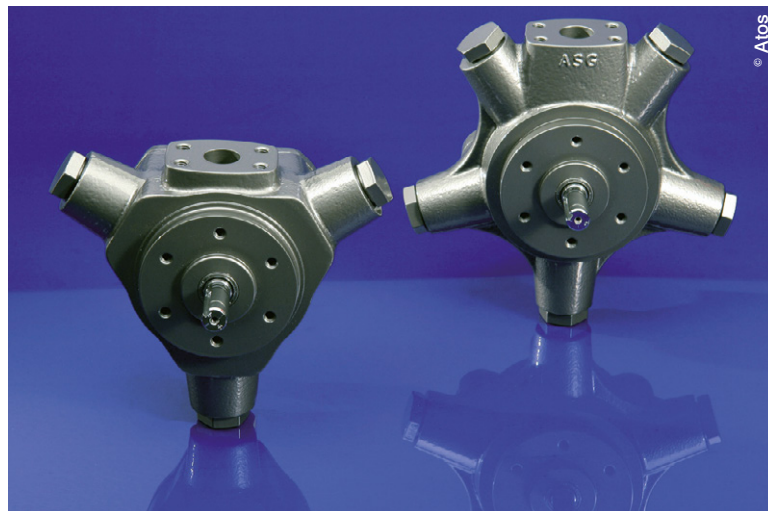
Les pompes à pistons radiaux PFR à cylindrée fixe d'Atos, développées pour des applications hautes pressions (350/500 bar), sont disponibles en pompes simples ou en configuration avec arbre passant.
