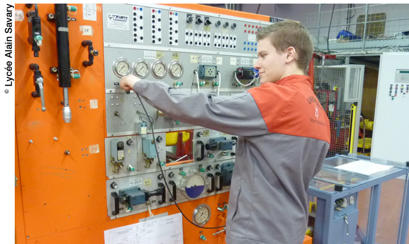
Un tout nouveau banc de simulation « Hydraulique proportionnelle et asservissements » a été installé sur le site et permet aux apprentis de s'initier aux mystères de la régulation.
