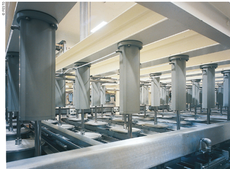
Les vérins pneumatiques de Festo sont notamment utilisés dans l'industrie agro-alimentaire; ici pour presser du fromage.
