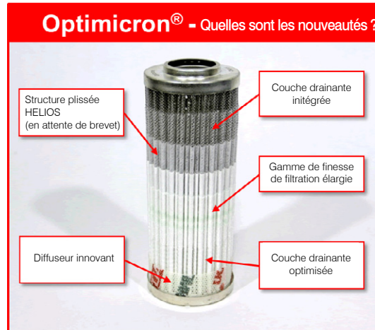
6. Aperçu global des innovations de l'élément filtrant Optimicron®
