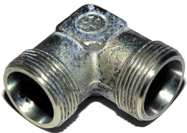
Après 500 heures : premières traces de rouille blanche.
