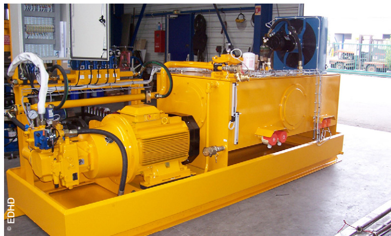
Centrale hydraulique de 1.000 litres équipée d'un GEP de 55 kW (220 l/min)
