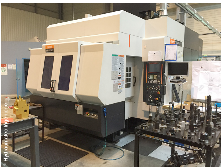
Centre Mazak Varisaxis 730 5X II pour l'usinage de blocs complexes en 5 axes.
