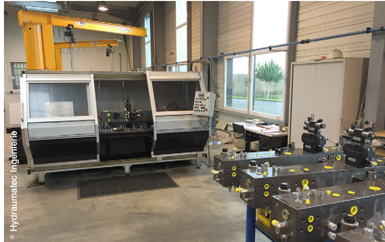
Nouveau banc d'essais de 90 kW, doté de deux pompes à pistons RKP à cylindrée variable de 90 l/minute chacune fonctionnant à une pression de 280 bar.
