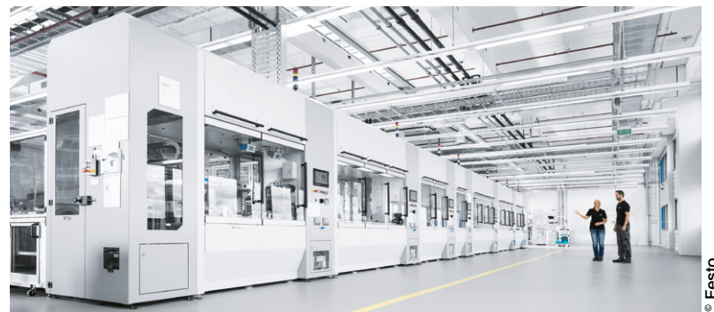
Assemblage automatique d'électro-distributeurs au sein de 8 cellules mises bout à bout sur une longueur de 30 mètres.
