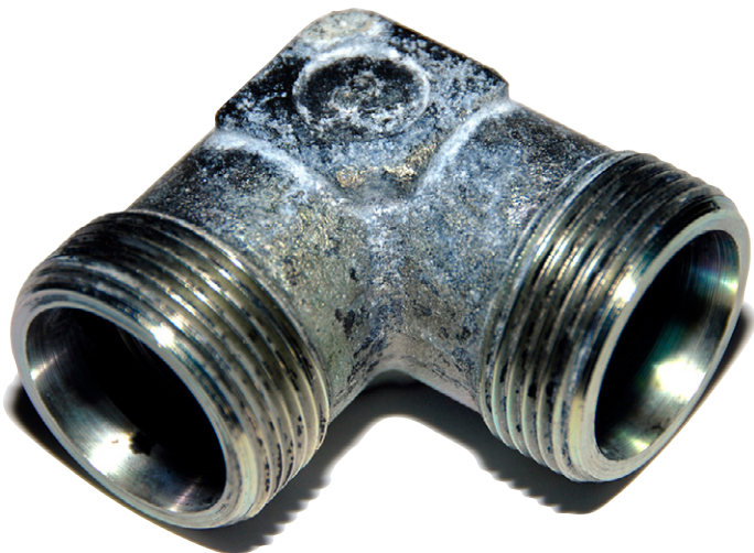
Après 1.000 heures : augmentation de la rouille blanche et absence totale de rouille rouge.
