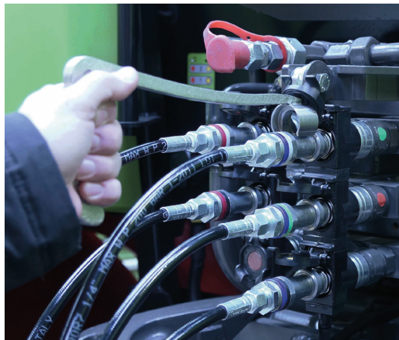
Hydrokit a déposé un brevet sur la poignée Cliphydro qui facilite l'accès aux coupleurs hydrauliques et réduit l'effort pour accoupler et désaccoupler en gardant les mains propres.
