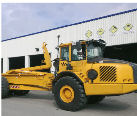
Rallongement d'un engin pour montage d'un bras Ampliroll
