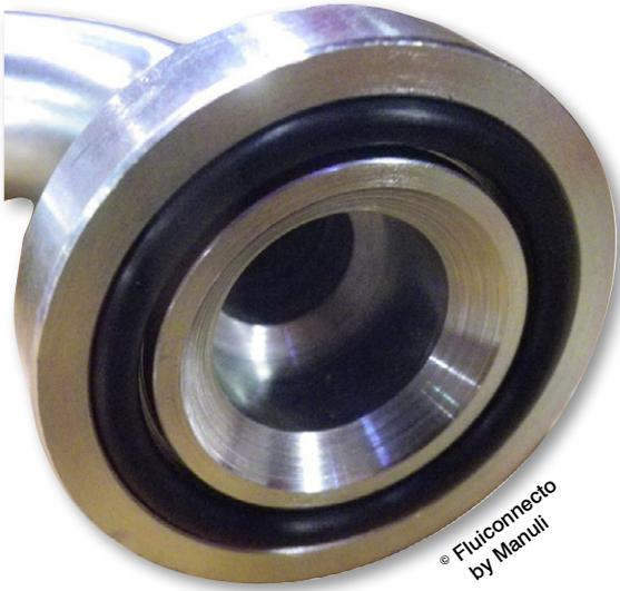
Fluiconnecto préconise l'emploi de raccords ORFS disposant d'un joint en face avant afin d'atténuer les problèmes d'étanchéité causés par des serrages répétés.
