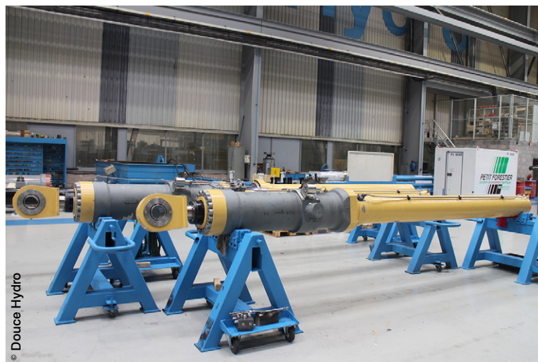
Douce-Hydro a breveté le système de sécurité Keralock®, un dispositif permettant de bloquer en quelques secondes le mouvement de la tige dès que celui-ci s'arrête.
