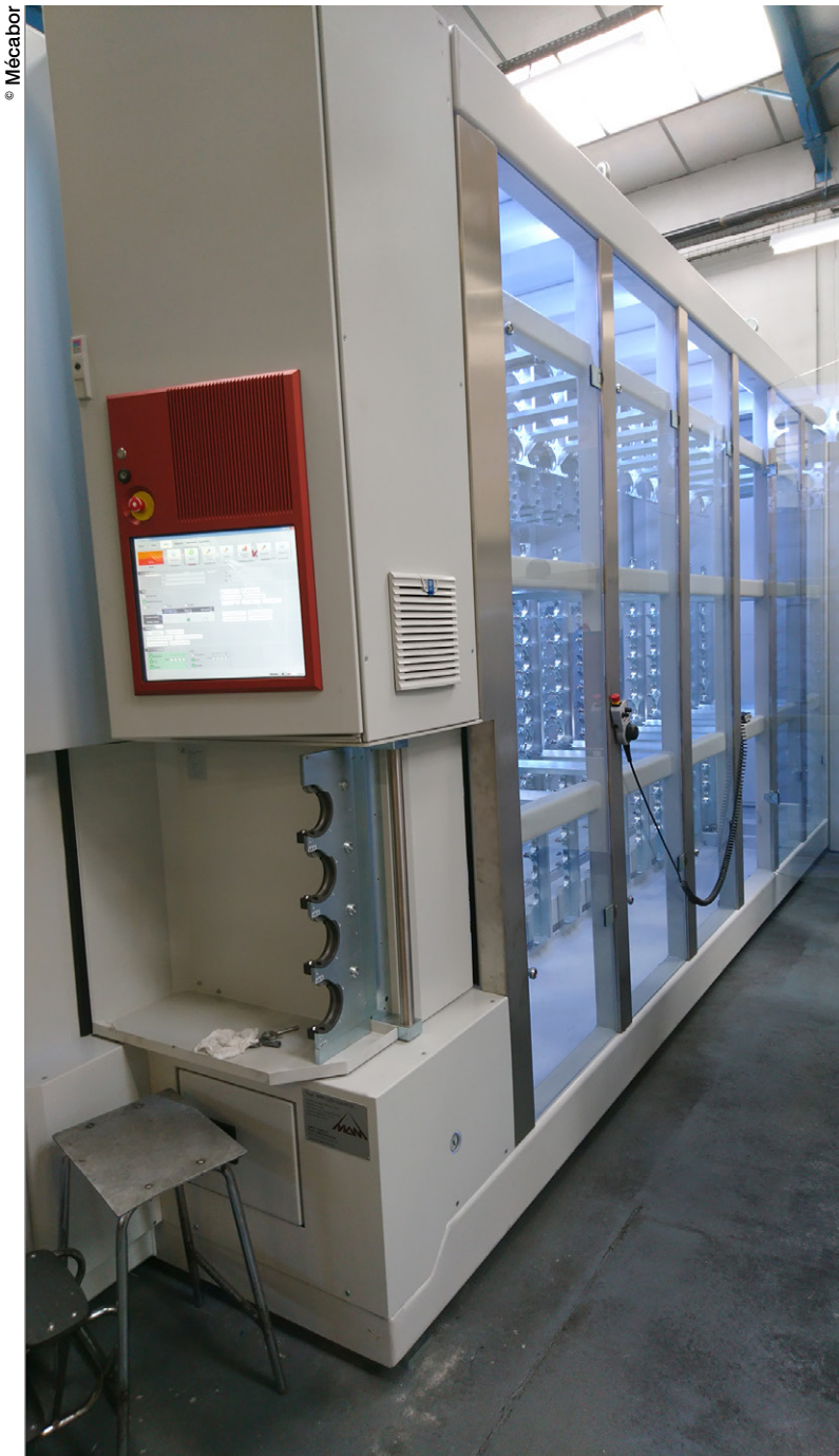
Les magasins sont reliés par un système de partage robotisé qui leur permet de communiquer entre eux et d'assurer une parfaite interchangeabilité des outils en fonction des besoins de la fabrication
