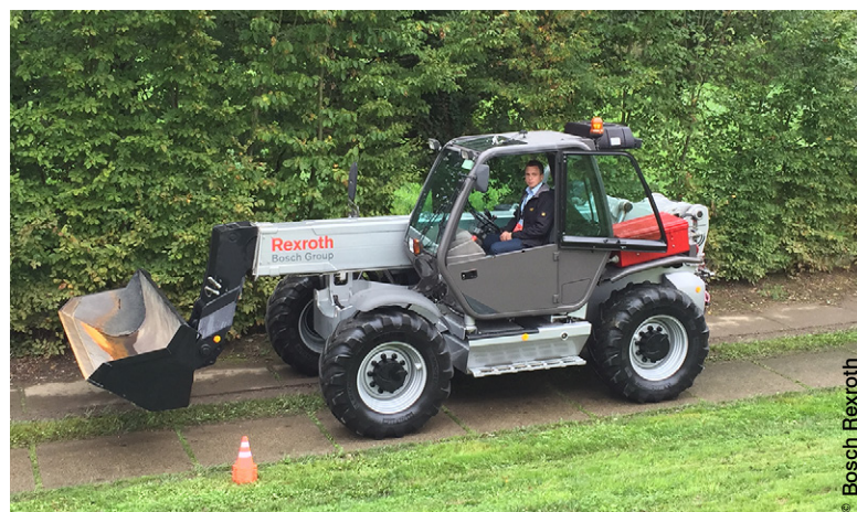
Démonstration pratique d'un véhicule équipée de la commande d'entraînement pour transmissions hydrostatiques Bodas-Drive DRC, solution logicielle personnalisable intégrant entraînement, confort, efficacité énergétique et sécurité intégrée.
