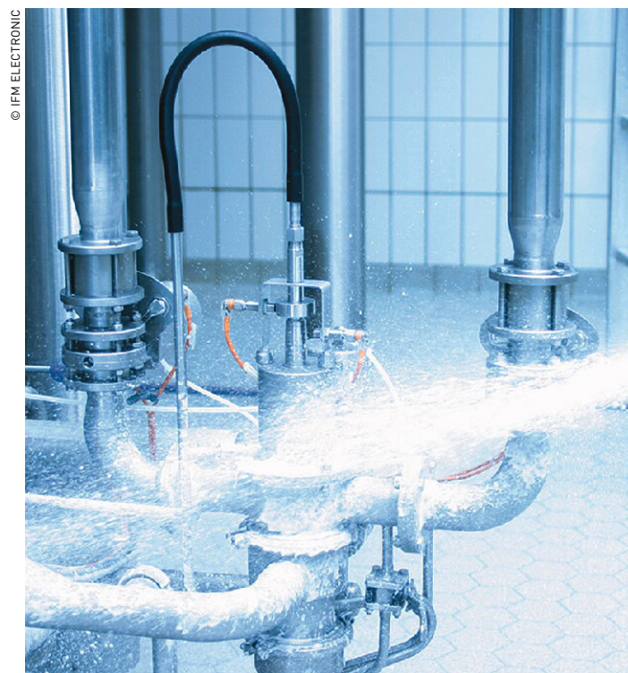
L'offre de capteurs d'ifm electronic s'est constituée en répondant à un « triptyque de contraintes » : résistance aux chocs thermiques, nettoyabilité et résistance aux produits lessiviels.
