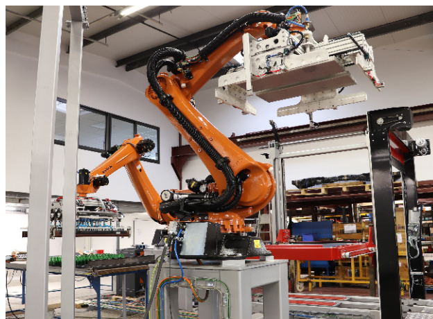
Cellule robotisée de palettisation de bouteilles réalisée par AR Techman pour Rémy Martin.
