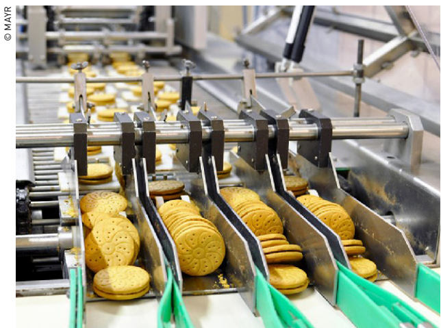
L'absence de contamination due à l'abrasion est une des caractéristiques du limiteur de couple magnétique Roba® contitorque de mayr®, dont le principe d'hystérésis assure une transmission de couple sans contact et donc sans usure.
