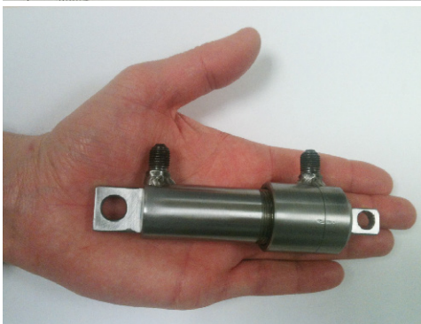
... aux plus petits vérins (390 grammes, course 50 mm, diamètre 20 mm)
