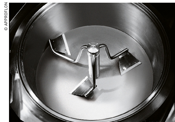
Inerte chimiquement, le PTFE répond aux normes d'alimentarité, présente une longue durée de vie, est anti-adhérent et possède une grande plage de tenue en température (photo : racleurs en PTFE installés sur un pétrisseur industriel).
