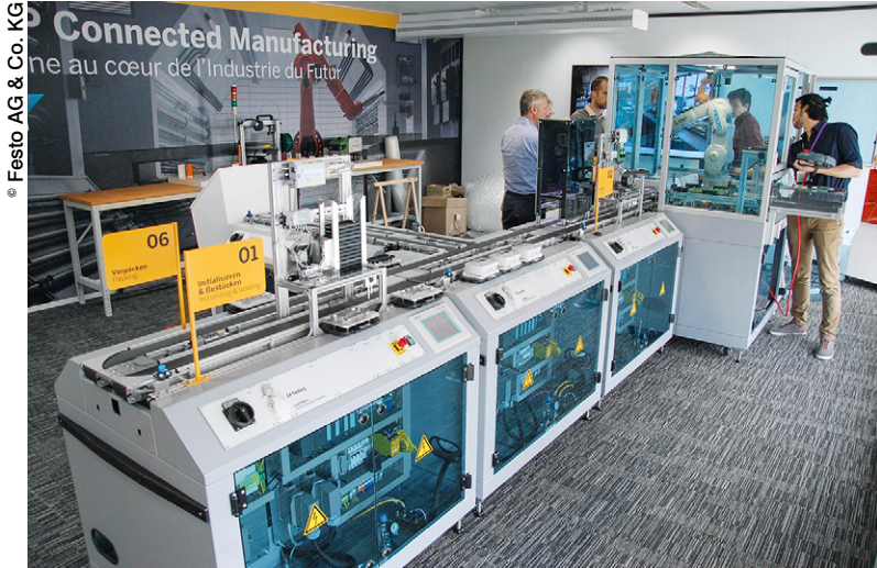
Une véritable solution Industrie 4.0 : l'Open Integrated Factory conçue dans l'Experience Business Center SAP, à Paris, démontre clairement comment intégrer production et technique de l'information.
