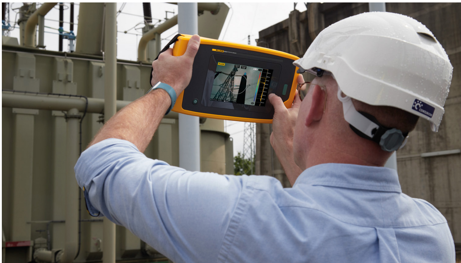
La caméra acoustique de précision ii910 permet de superposer une image SoundMap sur une image dans le visible afin d'identifier rapidement des petites baisses de pression ainsi que des fuites de faible densité à des fréquences comprises entre 2 et 100 kHz.
