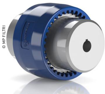
Transmettant parfaitement la puissance d'un moteur électrique à une pompe hydraulique, les joints de transmission en acier à denture bombée série SGDR de MP Filtri permettent de récupérer tout désalignement angulaire ou radial entre moteurs et pompes. Grâce à leur grande résistance aux coups et aux vibrations, ils constituent un élément d'une importance vitale dans les applications sur les équipements mobiles.
