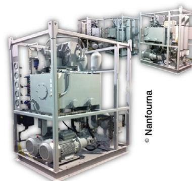
**Certifiées DNV, les centrales hydrauliques pour plateformes offshore réalisées par Nanfourma comprennent des composants Parker ATEX, des moteurs ABB et des réservoirs inox.**
