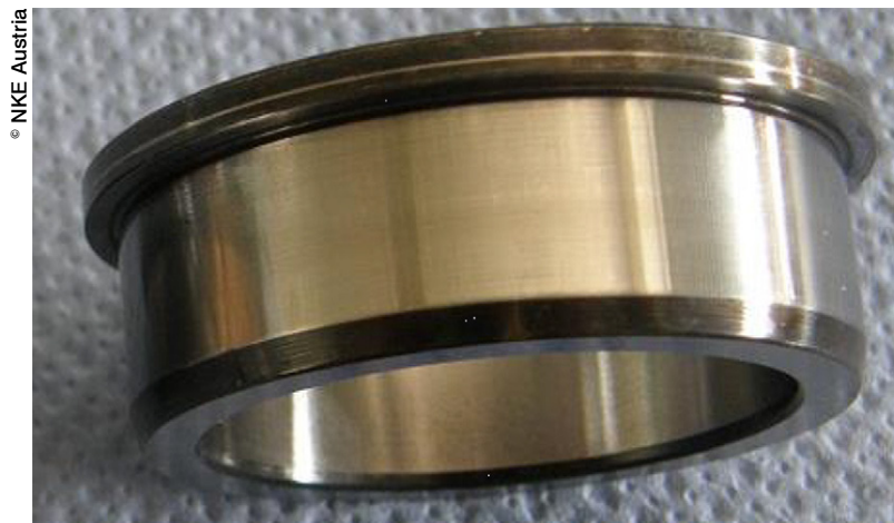
Fig. 3 : Bague intérieure d'un roulement à rouleaux cylindriques suite à un fonctionnement avec une huile suffisamment épaisse.
