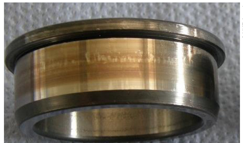
Fig. 2 : Bague intérieure d'un roulement à rouleaux cylindriques suite à un fonctionnement avec une huile trop fine.
