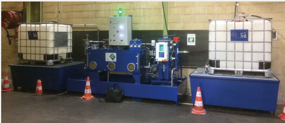
Pour Michelin, ID System Fluid a conçu un système de purification de l'huile permettant de traiter 500 litres de fluide pollué par jour.
