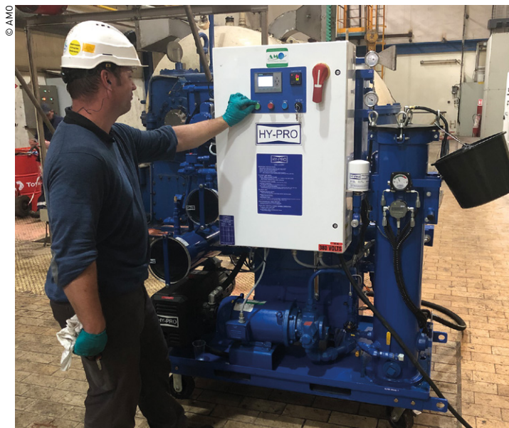
Le premier critère à considérer dans la gestion des fluides est la classe de propreté. Ici, dépollution d'une charge de turbo alternateur 5m 3 suite à la présence de particules et d'eau.
