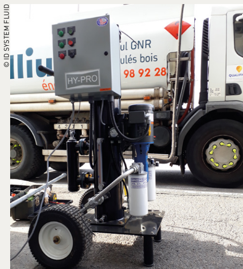
La filtration HyPro permet d'éliminer efficacement les pollutions dans les diesels, à l'origine de l'usure et de la casse des systèmes d'injection.
