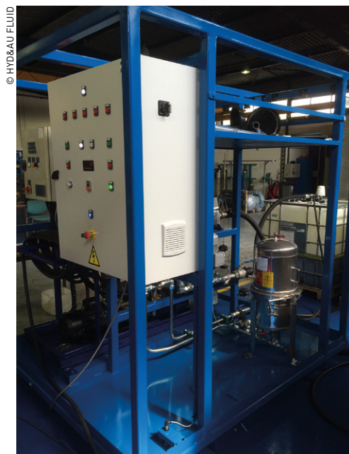
HYD&AU FLUID a développé un système de récupération des huiles usagées très polluées en eau et en particules baptisé PROSystème.
