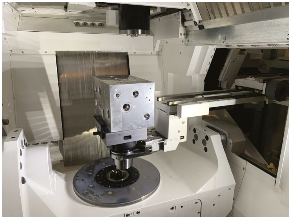
Le centre d'usinage dernier cri permet d'usiner le bloc sans avoir à le déplacer grâce à ses cinq axes simultanés.
