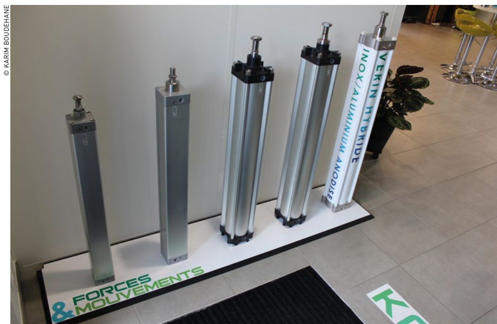
Tout à fait à droite, le vérin avec nez en inox démontable et tube en aluminium anodisé, pour les milieux agressifs.
