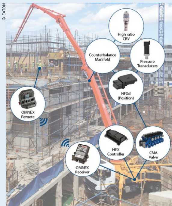
La technologie d'amortissement permet de réduire l'amplitude d'oscillation d'une flèche hydraulique jusqu'à 75% et la durée d'oscillation jusqu'à 90%.
