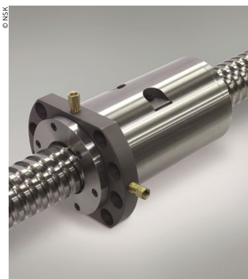
Le refroidissement de l'écrou élimine la chaleur à l'endroit même où elle est produite, maintenant ainsi une précision maximale à grande vitesse.
