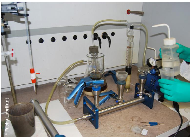
Un hydraulicien digne de ce nom se doit de filtrer le fluide avant le remplissage et avant tout montage du circuit, explique t-on chez Fuchs Lubrifiant
