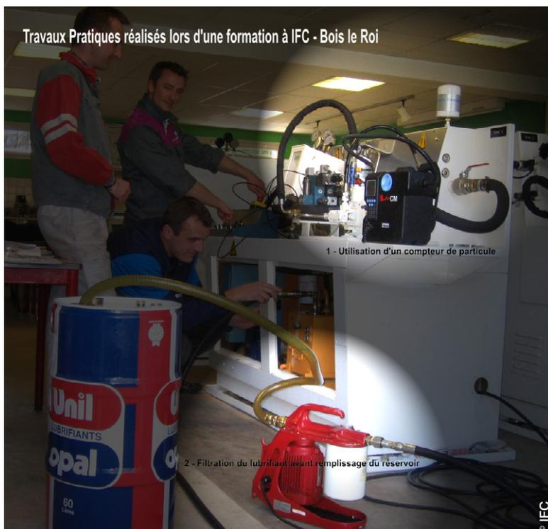
La filtration est abordée dans de nombreux stages proposés par l'IFC, avec simulation sur bancs et manipulation de compteurs de particules et de groupes de filtration.
