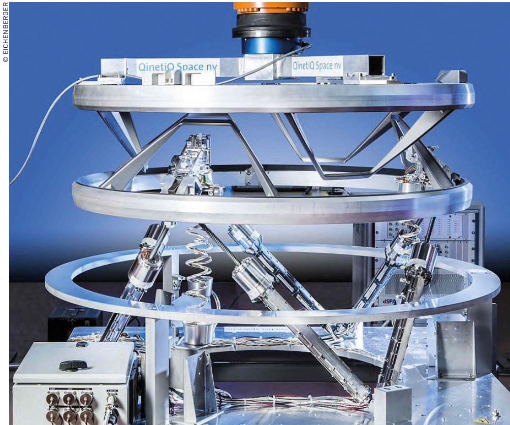
Le cœur du système d'arrimage de la station spatiale internationale se compose de trois entraînements par vis à billes Carry type F (16 x 16) résistant à la corrosion.
