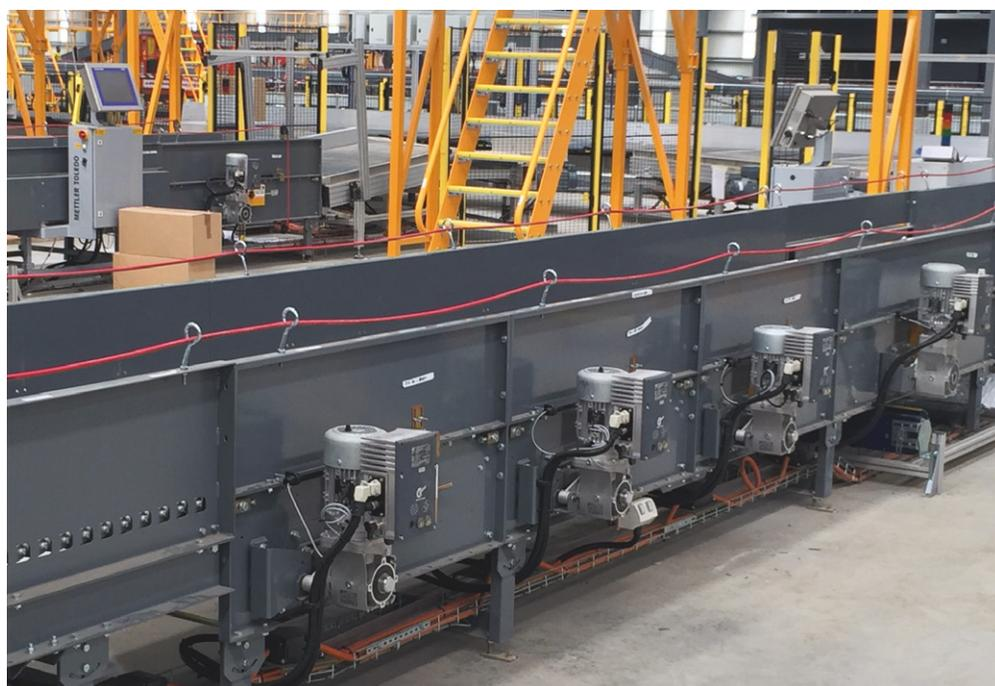
Plus d'un millier de moto-réducteurs/variateurs d'entraînement déplacent les tapis roulants de convoyage au sein d'une installation modulaire dans le centre de distribution des colis.
