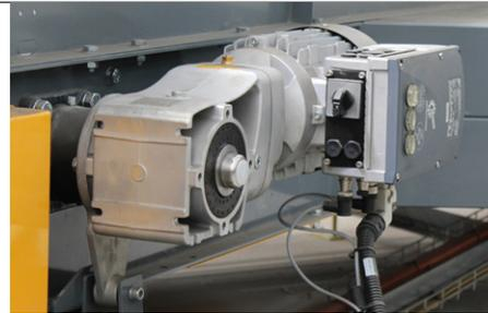
Les variateurs électroniques sont équipés d'un commutateur de maintenance pour une déconnexion du secteur sûre et un remplacement aisé.
