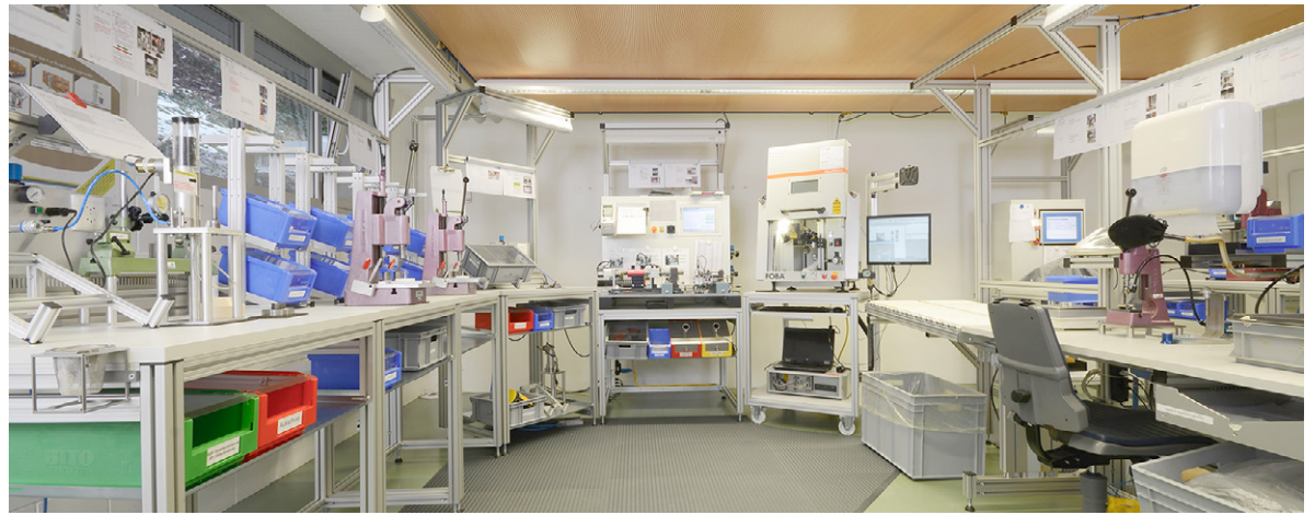
Les postes de travail de l'atelier d'assemblage ont bénéficié d'une réorganisation aux termes de laquelle chaque opérateur est devenu responsable de la totalité des opérations de montage des pièces (concept du « one piece flow »).
