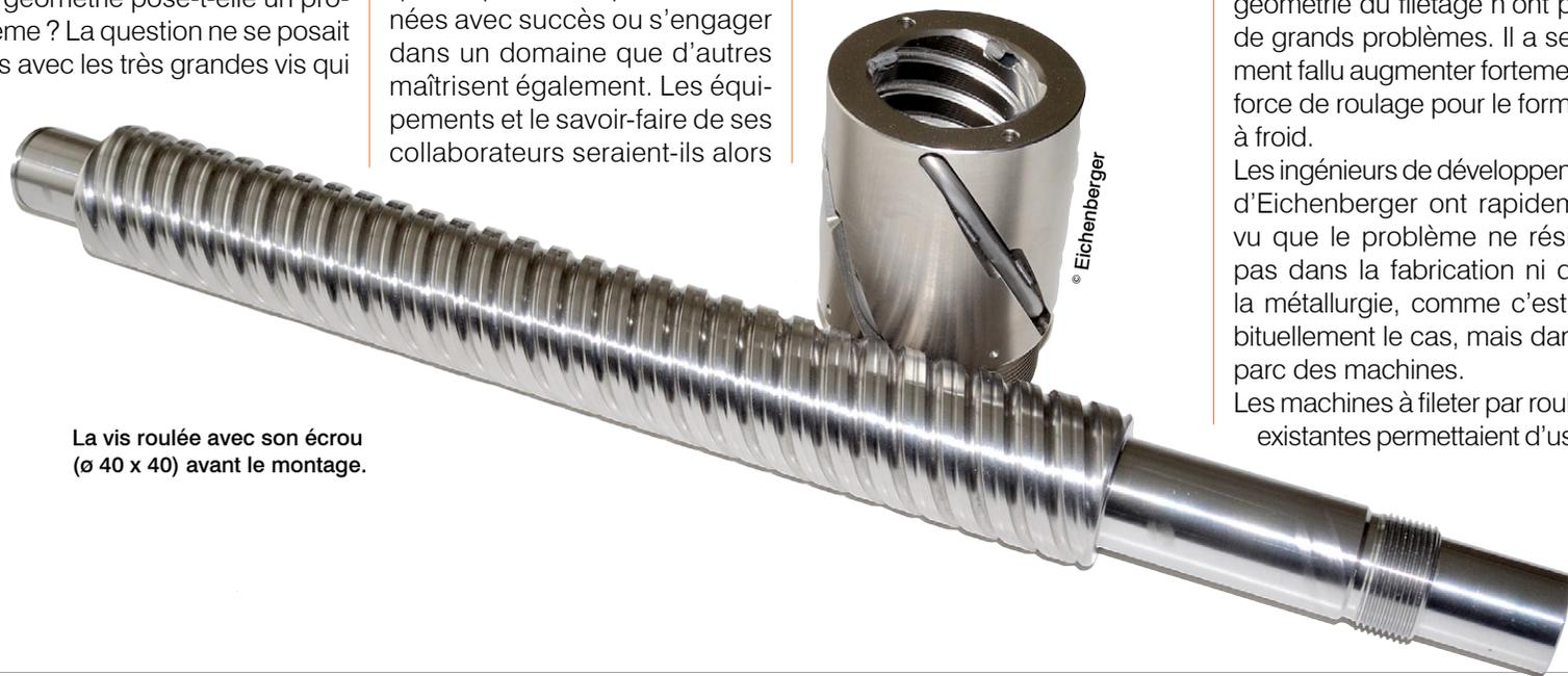
La vis roulée avec son écrou (ø 40 x 40) avant le montage.
