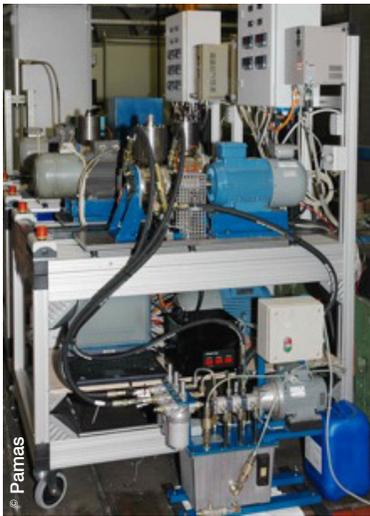
La technologie volumétrique permet de réaliser un décompte réel du nombre de particules polluant le fluide, affirme Pamas. Toutes les particules sont comptabilisées car le rayon laser parcourt l'ensemble de la cellule.
