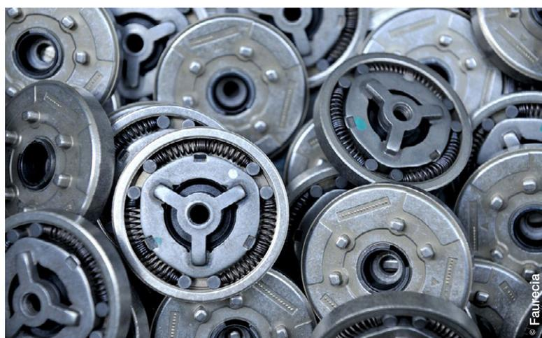
Étages commande GKN poignées à pompage version GZ : une des fabrications de l'usine de Caligny de Faurecia.
