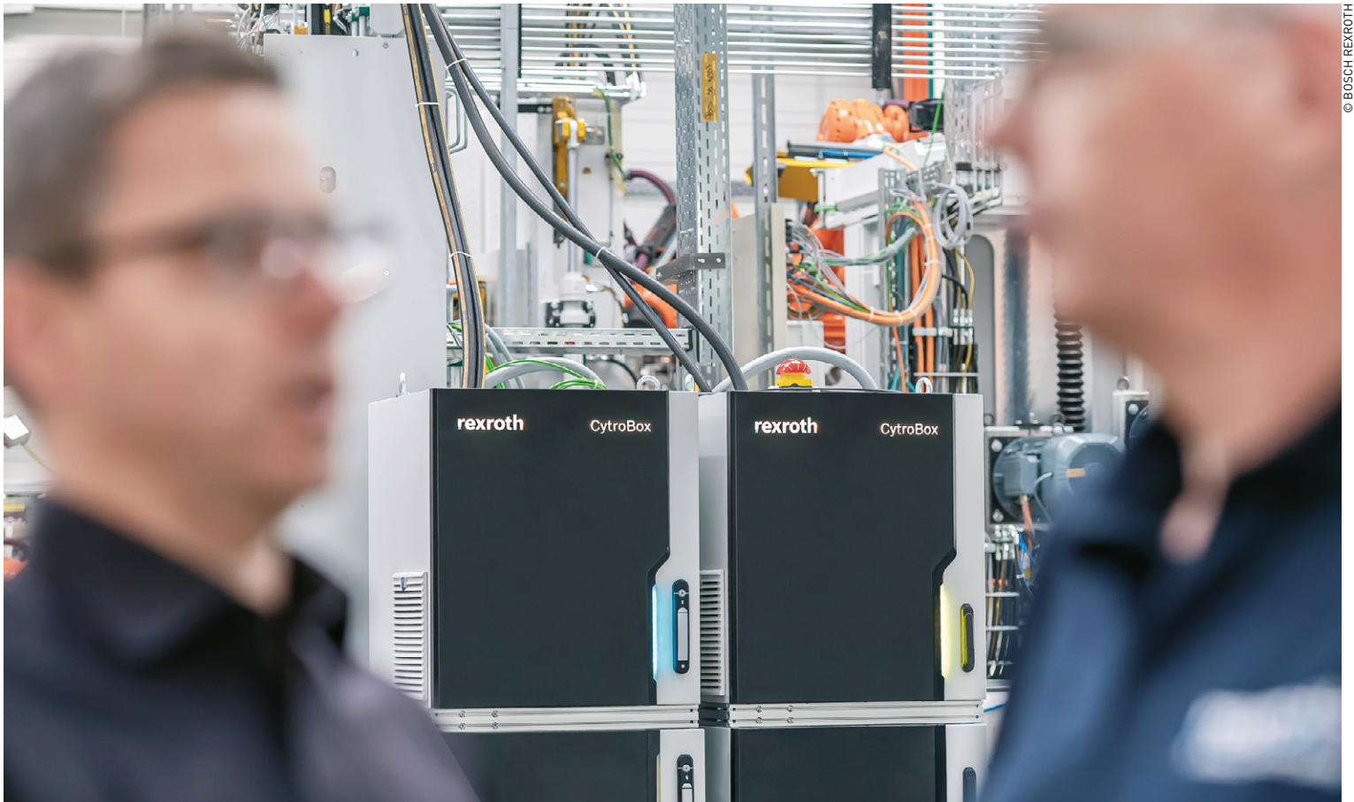
La Cytrobox est une centrale hydraulique compacte particulièrement adaptée à la machine-outil.
