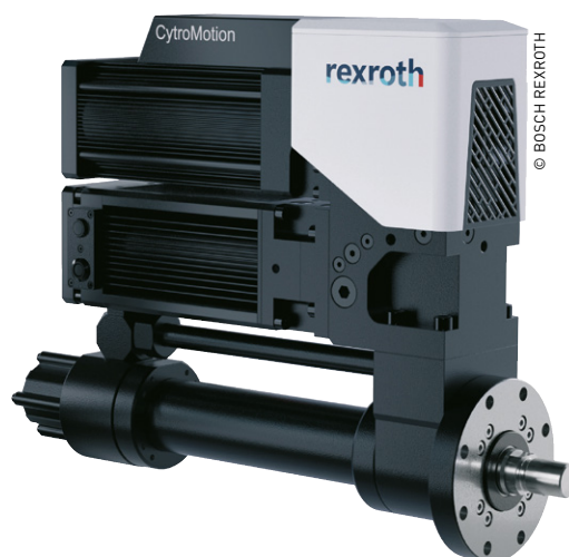
Cytromotion ne nécessite plus de centrale hydraulique, celle-ci est intégrée dans le vérin.
