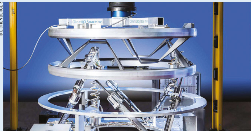
Le cœur du système d'arrimage se compose de trois entraînements par vis à billes Carry type F (16 x 16) résistant à la corrosion.
