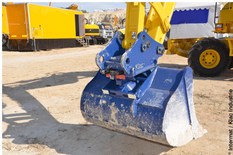
Un Silver Award a été remporté par Klac Industrie SA pour l'attache rapide Klac + pour pelles hydrauliques à verrouillage mécanique automatique.
