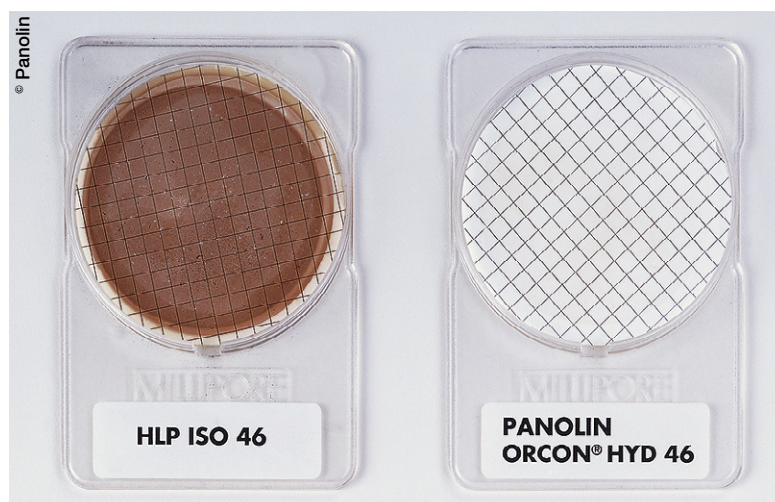
Filtre de gauche : dépôt solide après test d'oxydation ASDM.
