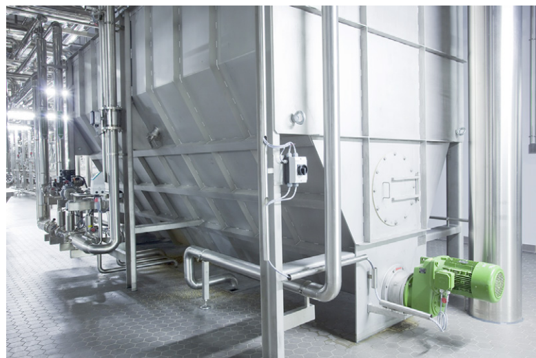
Un seul motoréducteur à arbres parallèles entraîne le convoyeur à vis.
