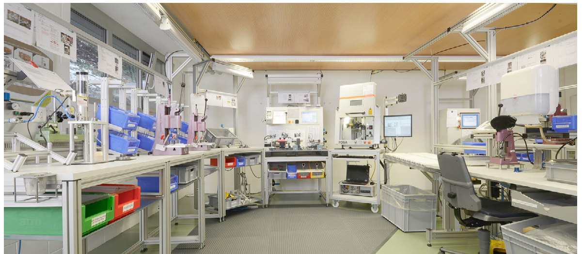
Salle de montage et d'essais : cellule de montage à flux continu en pièce à pièce.
