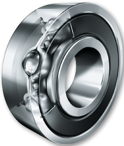
La conception du roulement de roue FAG à friction réduite avec joint ELS (Efficient Lip Seal) a permis de réduire la friction d'environ 30 % par rapport aux roulements de roue traditionnels.
