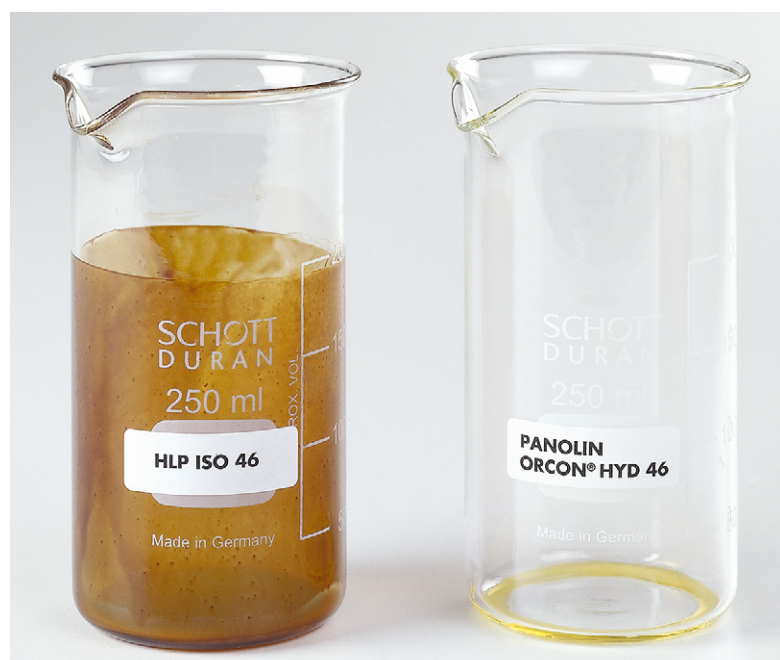
Éprouvette de gauche : résidu solide après test d'oxydation ASDM Éprouvette de droite : pas de résidu solide après test d'oxydation ASDM.
