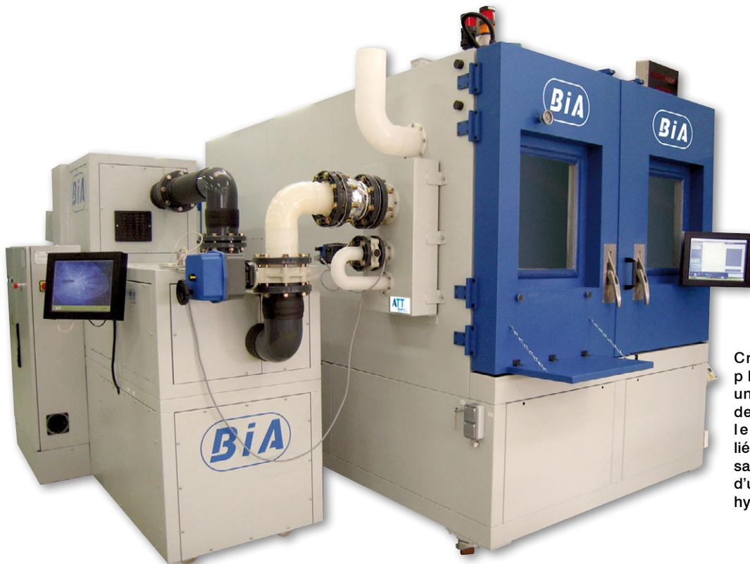
Création d'une plateforme unique capable de tester toutes les fonctions liées à la motorisation électrique d'une automobile hybride.
