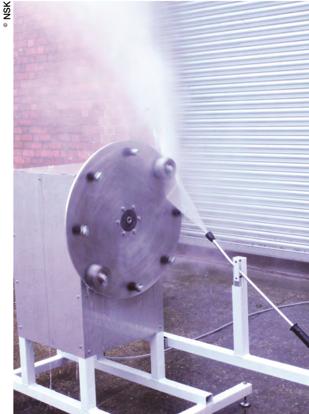
À l'issue de 200 h de tests par jet d'eau, aucune pénétration d'eau dans les roulements n'a pu être détectée.
