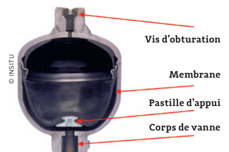
Figure 3 : Coupe d'un accumulateur à membrane
