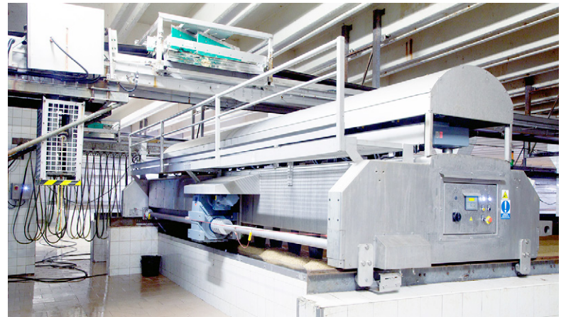
Mopos a remplacé et modernisé huit retourneurs pour caissons Saladin.
