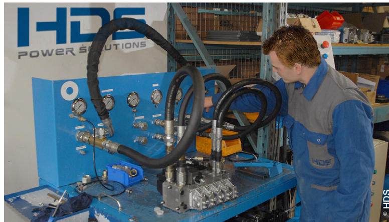
Banc de tests dédié à la gamme PVG de Danfoss Power Solutions
