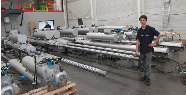
Les auto-vérins® brevetés se présentent sous la forme d'un ensemble complet et monobloc prêt à l'emploi et trouvent de belles applications dans tous les cas où les installations se révèlent difficilement accessibles
