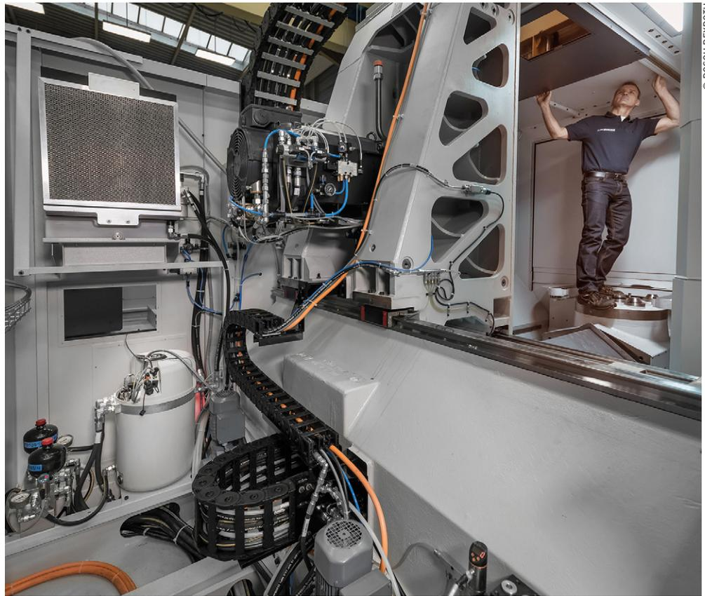
En bas à gauche, la centrale hydraulique dans son contexte, au sein du centre d'usinage.
