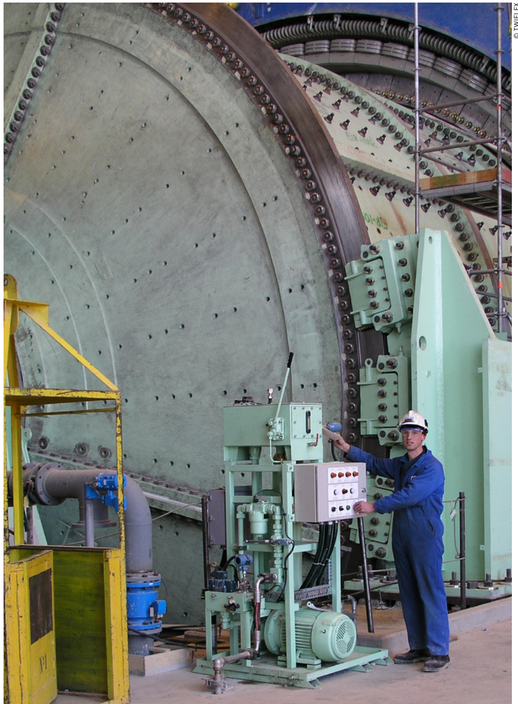
Les applications d'ingénierie les plus exigeantes peuvent demander des freins pouvant résister à un couple mesuré en millions de newtons mètres.
