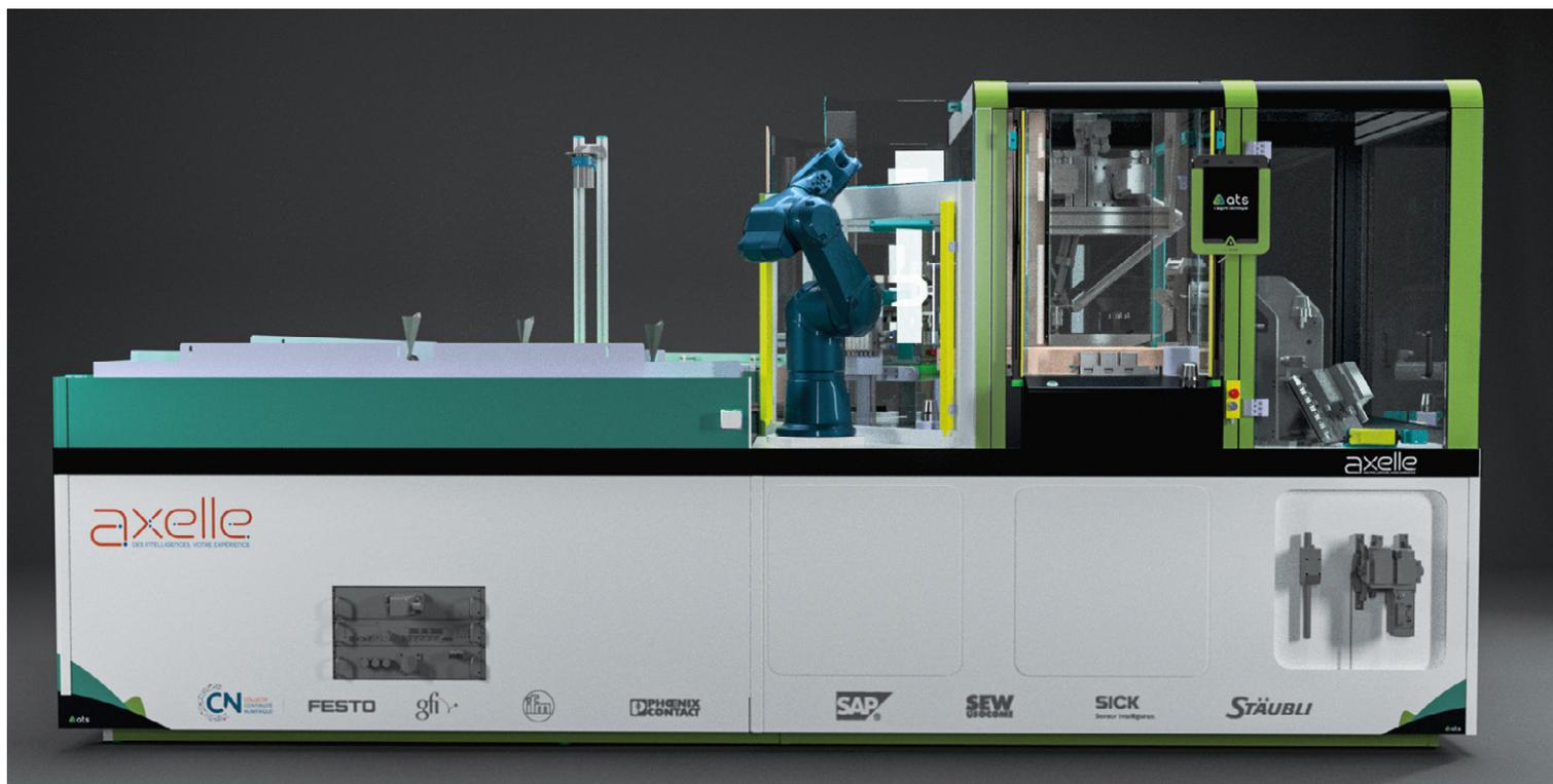
Axelle est une ligne d'assemblage automatisée composée d'un convoyeur, d'un poste robotisé d'assemblage et d'un chariot convoyeur autoguidé (AGV).
