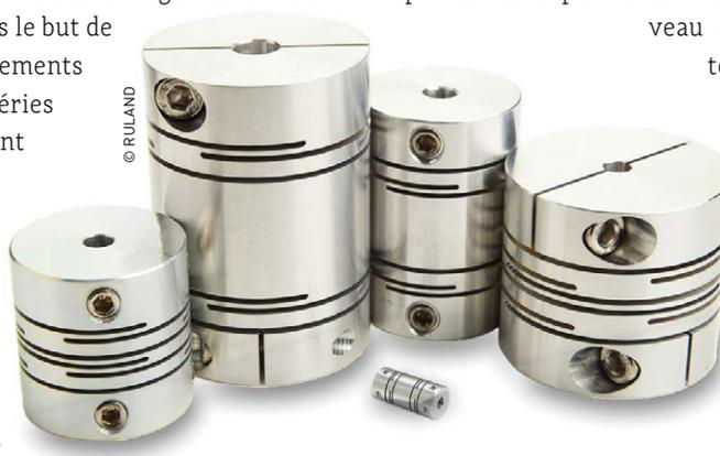
couples interrompues leur conférant un haut niveau de résistance à la torsion, aux couples à transmettre, une faible inertie et une longue durée de vie. Le format propriétaire des fentes se termine par des bords arrondis et non anguleux diminuant les contraintes pouvant survenir suite à des défauts d'alignement ou des surcouples.
