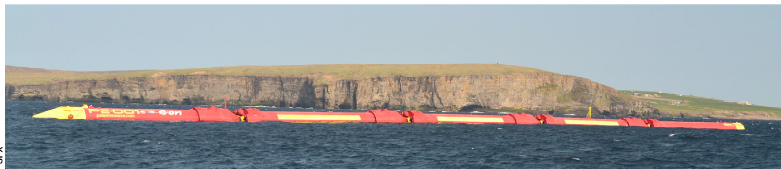
Ce serpent métallique de 120 m de longueur et 750 T réalisé par Pelamis Wave Power Ltd se présente sous la forme d'un train de cinq tambours flottants de 24 m de longueur et de 3,5 m de diamètre chacun, reliés par des charnières articulées
